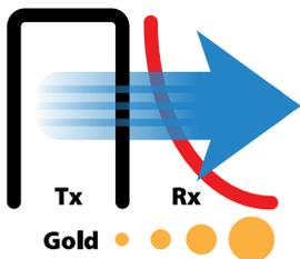
Die MPF (Multi Period Fast) Technologie sorgt für eine extrem schnelle Pulsinduktionsumschaltung zwischen Sendesignal (Tx) und Empfangs-Detektorsignalen (Rx). Daher liegen im Empfangszyklus nur minimale Rest-Sendesignale an. Dies ermöglicht eine klare und scharfe Erkennung von sehr kleinen Goldobjekten.
